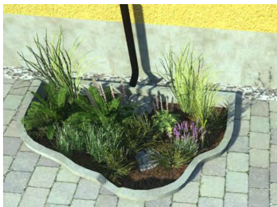
Principskiss för nedsänkt växtbädd med fördröjningsvolym ovanpå bädden. Växtbädden kan dräneras till underliggande mark genom perkolation, eller via dräneringsledning till dagvattennätet.
